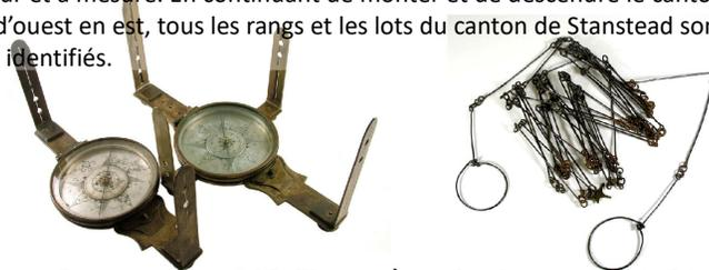
*Équipement d'arpentage essentiel de l'époque. À gauche, des compas magnétiques d'arpenteur (ou interféromètres). À droite, une chaîne de Gunter, utilisée pour mesurer la distance. Une chaîne complète mesurait 66 pieds de long, et était divisée en 100 maillons. Un mille terrestre correspondait à 80 longueurs de chaîne. La chaîne devait être tirée avec force, les chaîneurs devaient donc avoir des bras forts.*
